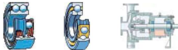
ภาพตลับลูกปืนติดตั้งใช้งานในบีม
